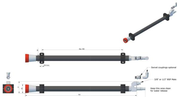
**ROV LONG ZERO-THRUST CAVITATION
